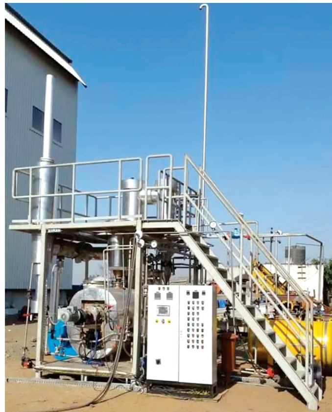
भारतीय पेट्रोलियम संस्थान, देहरादून द्वारा विकसित बेंच रिएक्टर संयंत्र द्वारा प्लास्टिक कचरे से ईंधन निर्माण
